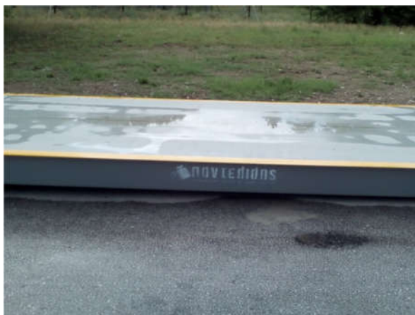
Φωτογραφία 5. Το απολυμαντήριο στη δεξιά λωρίδα κυκλοφορίας του ρεύματος εισόδου.
